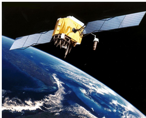
Figuur 5.1: 'n Kunstenaarsvoorstelling van 'n GPS satelliet wat om die aarde wentel. Daar is ten minste 24 GPS satelliete operasioneel op enige spesifieke oomblik. GPS gebruik 'n toepassing van trigonometrie, wat bekend staan as triangulering, om iemand se posisie te bepaal. Die akkuraatheid van GPS is binne 15 meters.
