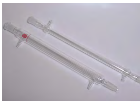
Twee Liebigkoelers wat vir distillering gebruik word.
