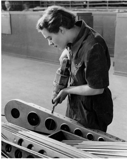
'n Dame gebruik 'n elektriese boor om 'n gaatjie in 'n vliegtuigonderdeel te maak.
