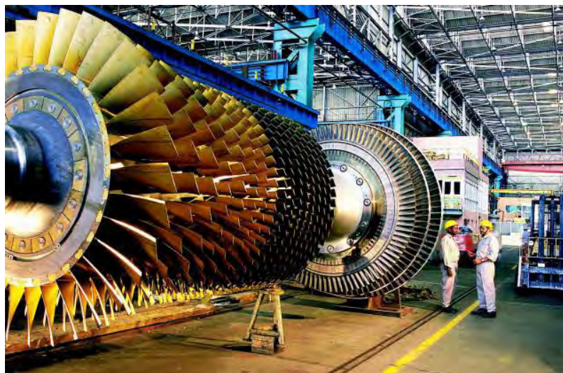
'n Stoomturbine met die buitenste omhulsel verwyder.
