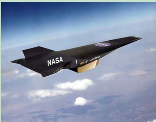
NASA se supersoniese stustraler, die X-43, vlieg teen 7000 km/h.
