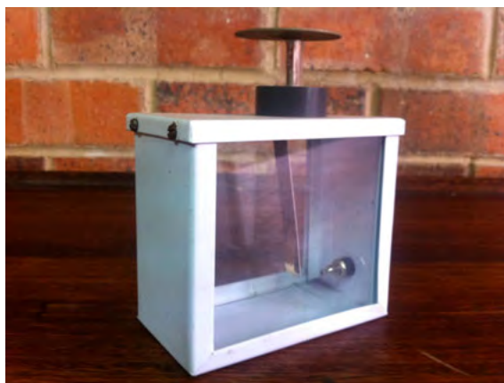
'n Elektroskoop wat in 'n laboratorium gebruik word.
