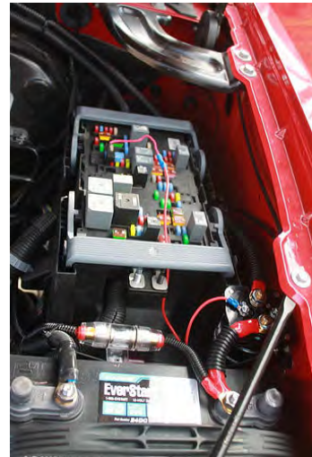
Motors het ook smeltdrade. Sien jy die smeltdraad op hierdie foto van 'n motorbattery?
