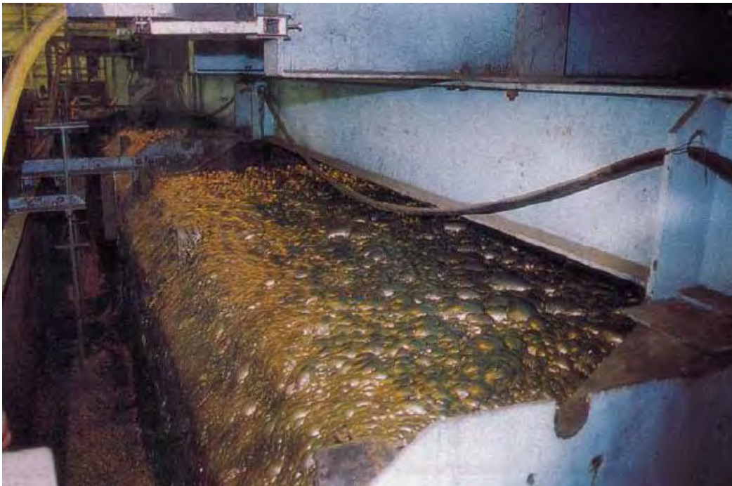
Die skeiding van minerale deur flottering.
