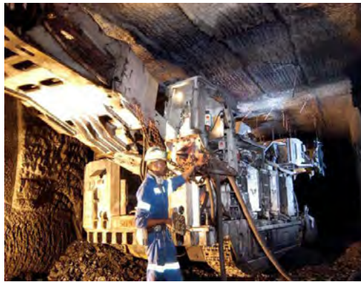
'n Masjien wat kontinu-delwer genoem word, aan die werk by die steenkoollaag.
