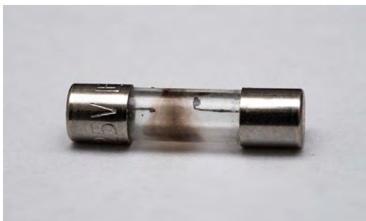
Hierdie smeltdraad het gesmelt en moet vervang word.
