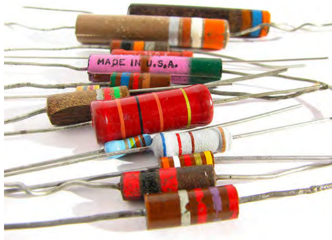
Verskillende tipes resistors wat gebruik word om weerstand tot 'n stroombaan toe te voeg.
