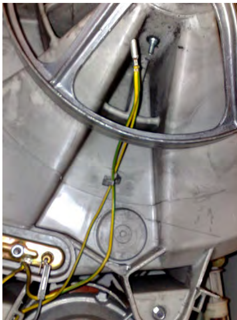
Die groengeel aardedraad gekoppel aan die metaalomhulsel aan die binnekant van 'n elektriese motor.
