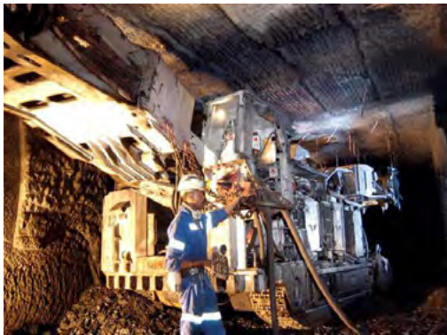
'n Masjien wat kontinu-delwer genoem word, aan die werk by die steenkoollaag.
