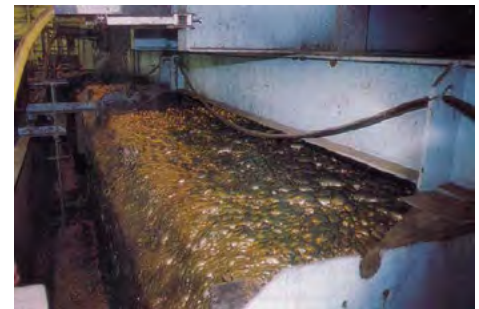
Die skeiding van minerale deur flottering.
